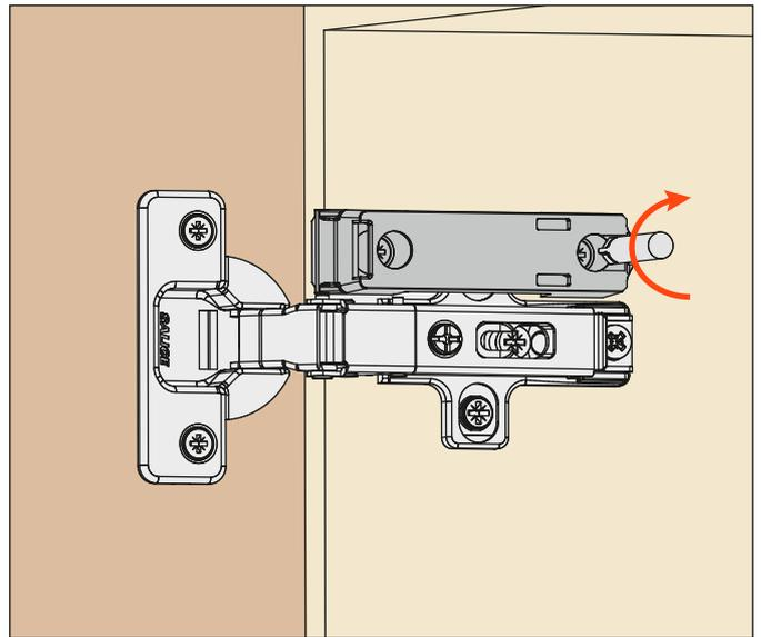
Insérer le porte-Smove en le faisant glisser dans le sens de la flèche.
