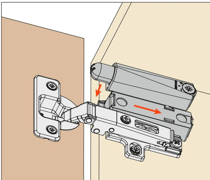
Il est possible d'augmenter ou de réduire la force de l'amorti en agissant sur la vis indiquée.
