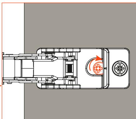
**3)** Tourner la vis excentrique de fixation.
