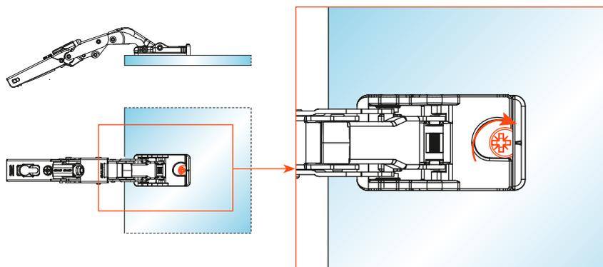
**3)** Tourner la vis excentrique de fixation.
