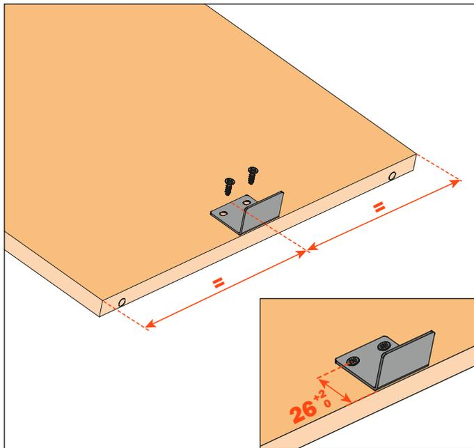
1 B) Fixation de l'équerre sous la tablette coulissante avec l'attache coulisse arrière. Dans ce cas, l'équerre doit être alignée, en retrait, avec l'attache coulisse arrière.
