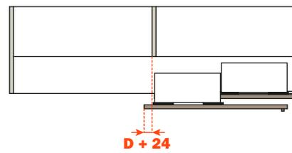
\*Profondeur min. pour le mécanisme motorisé
