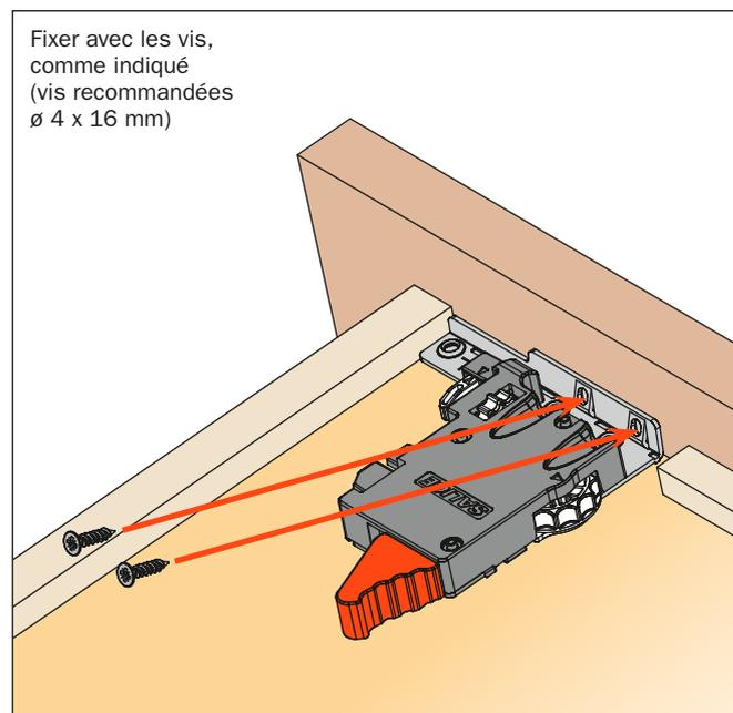
Il est conseillé de pré-percer le fond ou la façade avec le **gabarit de perçage SGD704UGXA**, voir page 35.
