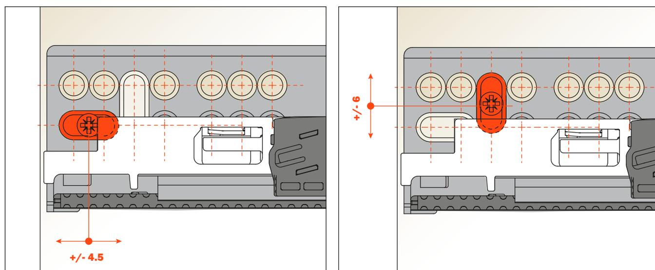
**Position des trous de fixation de la coulisse sur le côté du meuble**
