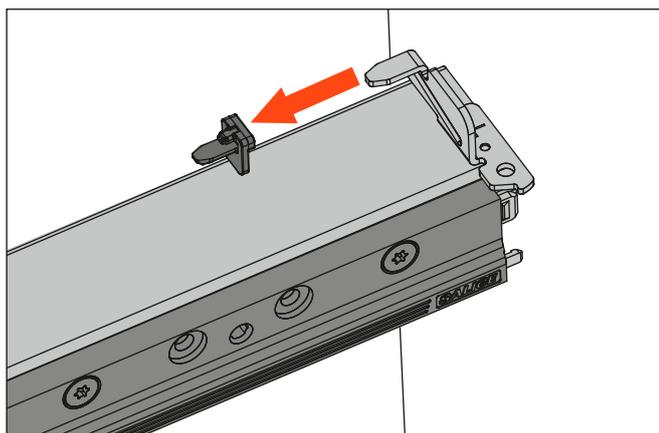
Insérer le levier pour le réglage de l'inclinaison, à droite et à gauche
